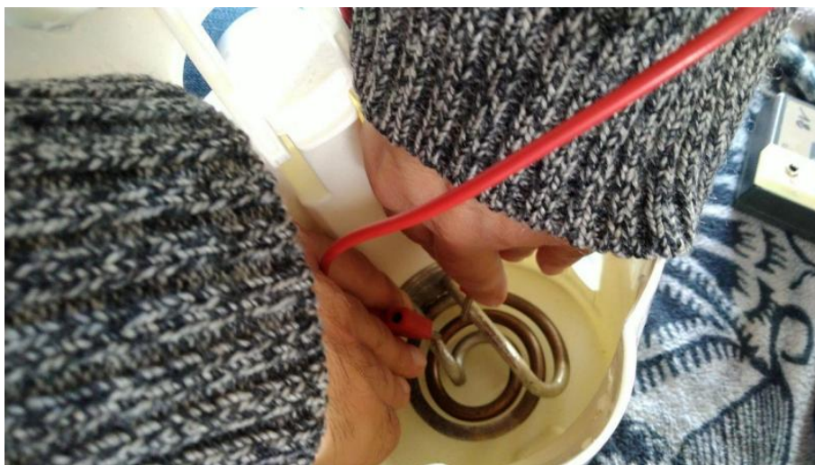
FIGURE III.1 – Mesure approximative de la résistance de la bouilloire, une mesure propre se ferait après démontage de la résistance pour l'isoler. Une fois démontée la résistance mesurée est 47 \Omega .
