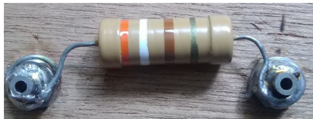
FIGURE I.1 – Photo d'un conducteur ohmique avec des anneaux orange, blanc, marron et doré indiquant une résistance théorique de 390 \Omega (ohms).
