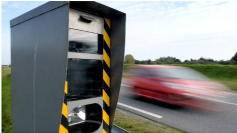
Un radar de police est un sonar terrestre qui envoie deux ondes très rapprochées à chaque détection d'un véhicule en approche. Connaissant l'intervalle de temps entre les 2 envois et les temps de réception de la 2e onde par rapport à ce qui est attendu pour une vitesse maximale, l'appareil peut calculer la vitesse du véhicule et ainsi prendre une photo du véhicule (ou pas si l'automobiliste a respecté les vitesses).
