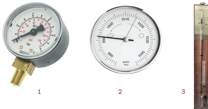
FIGURE 1.11 – (1) Un manomètre, (2) un baromètre circulaire et (3) un baromètre de Torricelli.
