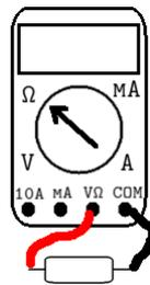
FIGURE 6.14 – Mesure directe d'une résistance de conducteur ohmique.
